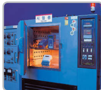
Испытание непрерывным воздействием высокой температуры
